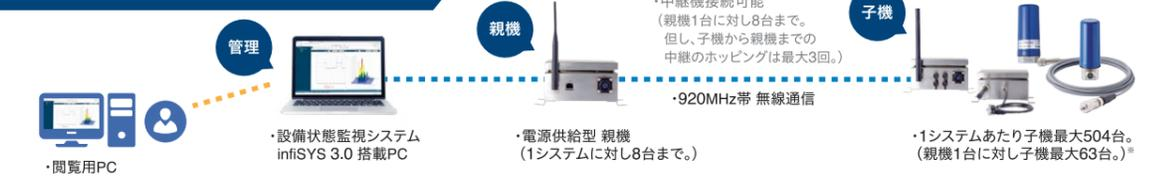
※バッテリー型子機(センサー一体タイプ、センサ分離タイプ)の場合です。電源供給型子機、バッテリー型子機(センサ分離タイプ、耐環境対応)の接続台数は親機1台に対し、最大8台となります。
