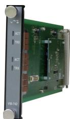
VM-7モニタリングシステムとDCS(Distributed Control System)、PLC (Programmable Logic Controller)やあらゆる制御システム間でのデータの送受信を行います。また、infiSYSビューステーションとも直接通信します。
