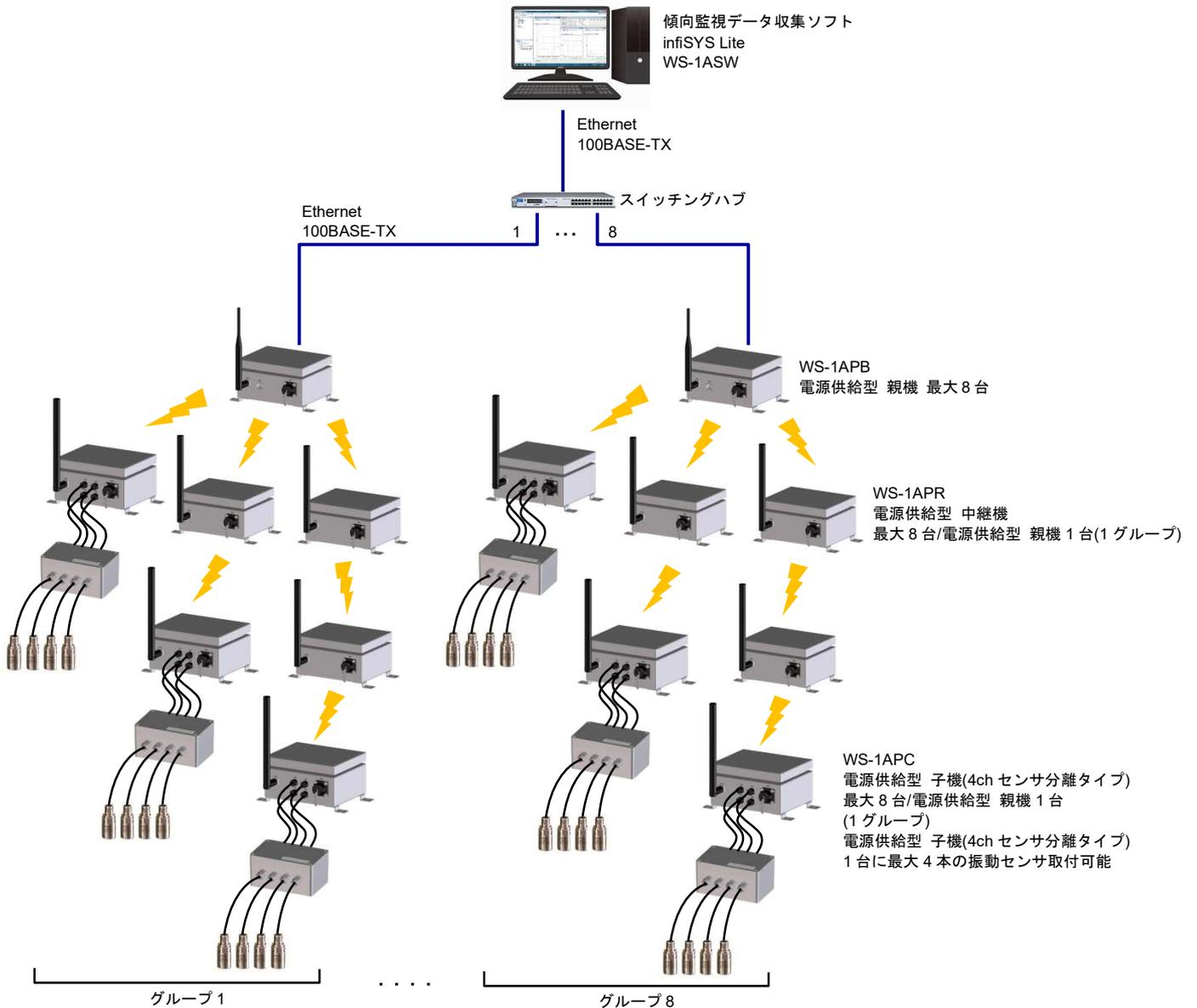
電源供給型 子機(4ch センサ分離タイプ)を 8 グループ接続
