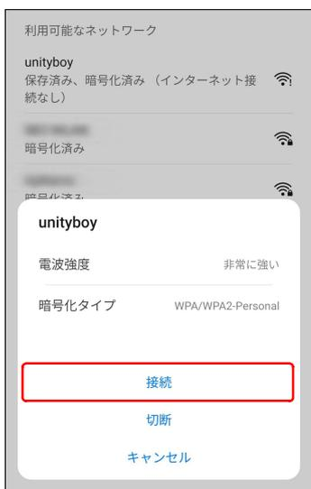
初回接続時はパスワードの入力を求められるので、アクセスポイント設定ファイルで設定したパスワードを入力します。
