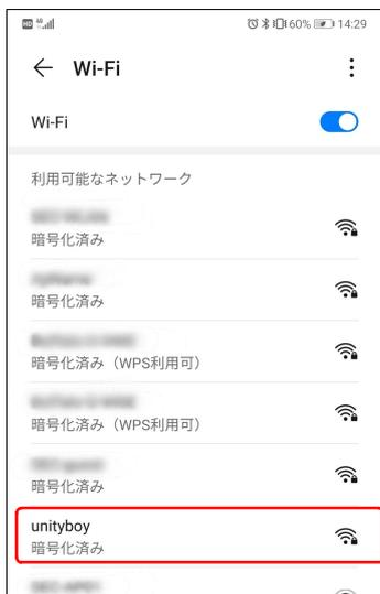
無線LANの接続設定画面を開き、利用可能なネットワークから、アクセスポイントモード設定ファイルで設定したSSIDを選択します。
