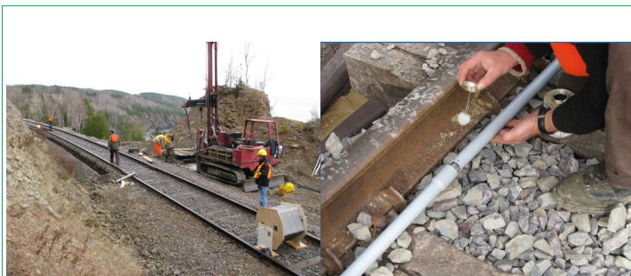
Fig.1 SAA設置のため塩ビ管を接続 (SAA+PVC)
