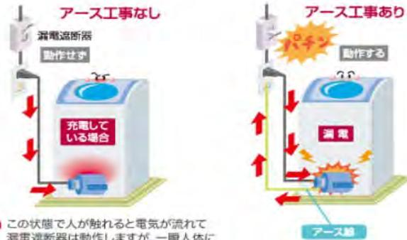
❶ この状態で人が触れると電気が流れて漏電遮断器は動作しますが、一瞬人体に電気が流れますので危険です。
