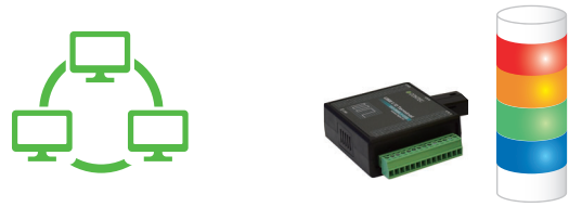
I/O デバイス (24V) で設備に報せる
