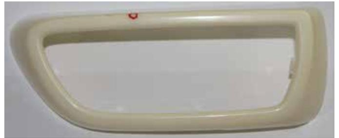
エアVENTカバーパネルの側面 (赤い丸は欠陥部分)
