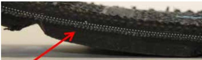
自動車タイヤ試料の断面 (矢印)、上部が内側表面
