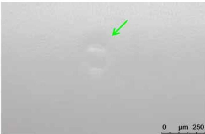
自動車の樹脂製エアVENTカバーパネルの欠陥部位：リング照明
