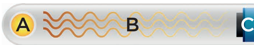
図1. 赤外検出器がCO 2 分子の赤外線吸収を検出 A: 赤外線光源 B: 光路 C: 検出器
