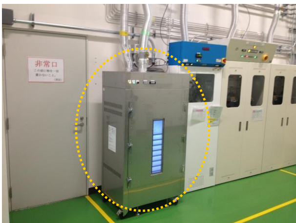
電子部品製造工場 発生ガス抑制対策 ホルムアルデヒド濃度低減対策
