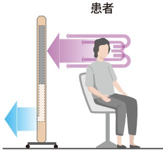
患者からの飛沫による感染防止と同時に、室内空気の清浄化が行えます。
