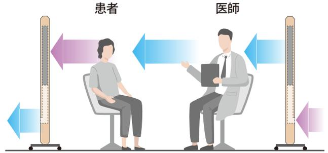
2種類のクリーンパーテーションを組み合わせることで、空気感染防止と室内の空気清浄化に最大限の効果を発揮します。医療従事者への感染防止効果が期待できます。
