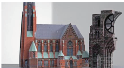
モデルは0.012mmの精度でカットされ、高さ方向の精度は0.1mmです
