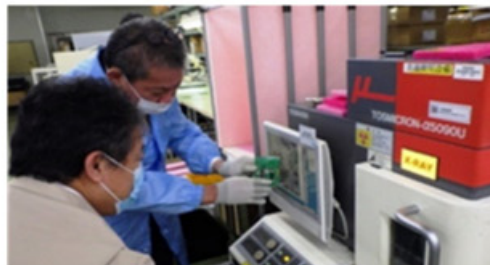
リフロー実装後のはんだ中のボイド含有率確認
