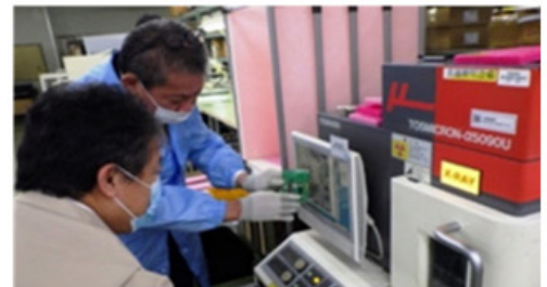
リフロー実装後のはんだ中のボイド含有率確認
