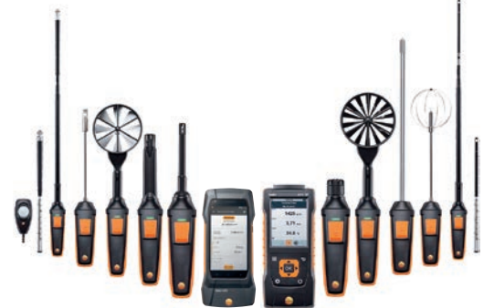
testo 400 (中央左)とtesto 440 (中央右) 左右は共通の接続プローブ
