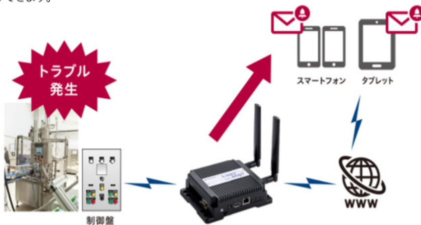
現場のデータを監視できる「UnityBoy」製品
